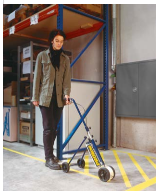
Przejezdny przyrząd do znakowania typu 50, na 1 puszkę farby
