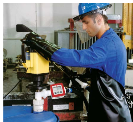
Zestaw pompy z mechanizmem z PVDF (polifluorku winylidenu)
