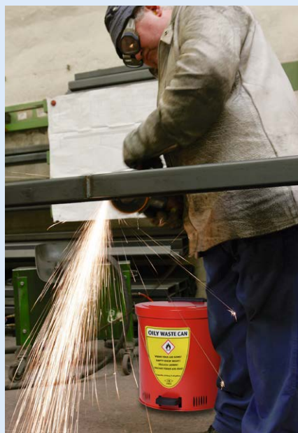
Samoczynnie zamykająca się pokrywa zapobiega zapaleniu się zawartości, np. od iskry.
