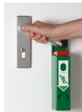
Po pokonaniu oporu klamki kontroler drzwi otwieranych jednorącz automatycznie przesuwają się na dół i umożliwia otwarcie drzwi ewakuacyjnych jednym ruchem. Włącza się przy tym alarm ciągły, który można wyłączyć kluczykiem
