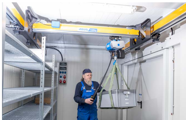
Urządzenie dźwigowe do podnoszenia i transportu dużych ciężarów w obrębie systemu magazynowego.
