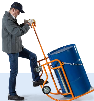
Bez trudu można przewrócić beczkę za pomocą pałków wywrotki i przestawnej dźwigni
