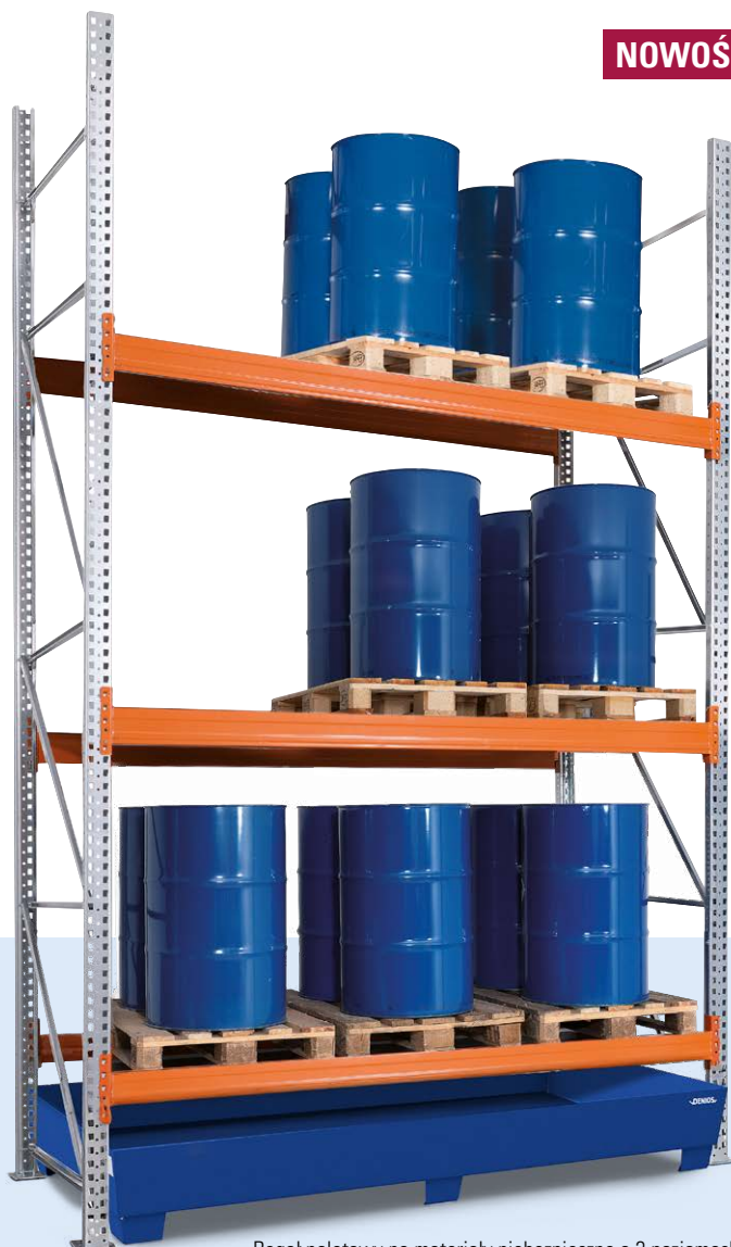
Regał paletowy na materiały niebezpieczne o 3 poziomach składowania, stalowa wanna wychwytywa, część główna, wymiary półki (szer. x głęb.) 2700 x 1100 mm
